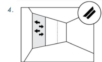
4. Marouflez à partir du haut, en effectuant un mouvement du centre vers l'extérieur avec une brosse ou un chiffon propre pour chasser les bulles d'air et le surplus de colle.
