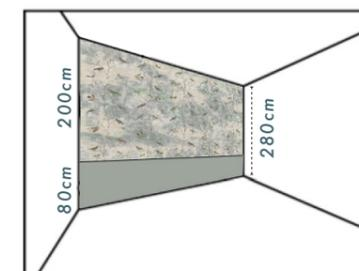
Exemple d'une pose avec un sous bassement de 80cm et baguette de séparation.
